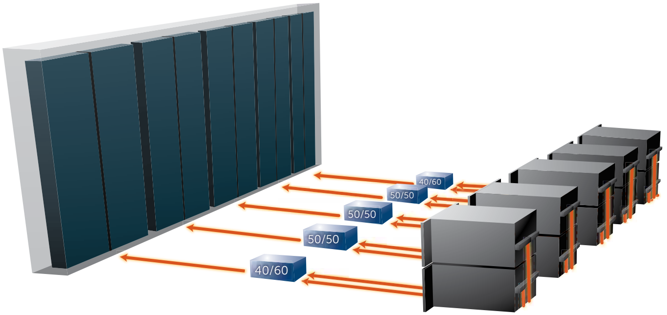
Ascent DMS 장비는 각 케소드의 스퍼터링 속도를 개별적으로 제어합니다. 하나의 챔버의 멀티 케소드 시스템에서 고정 50/50 Duty cycle을 갖는 AC 장치보다 더 균일한 타겟 마모 및 스퍼터링을 할 수 있습니다.
