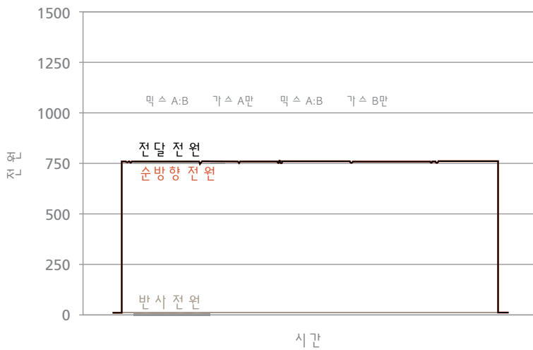
그림 3. 가스 유량 전환 동안 Paramount™ 전원 전달 시스템 소인 주파수 동조는 공정 과도 현상을 통해 매우 신속한 동조를 제공하여 반사 전원과 VSWR을 최소화하고 전원 전달 효율을 보장합니다.
